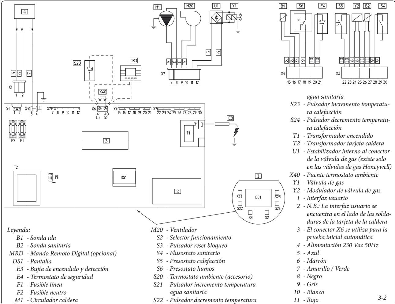
La caldera está preparada para la aplicación de termostato ambiente (S20), cronotermostato ambiente On/Off, reloj de programación o de un Mando Remoto Digital (MRD). Conectar en los bornes 40 - 41, eliminando el puente X40.
