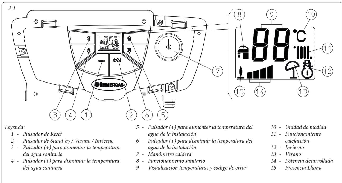
**Encendido de la caldera** (Fig. 2-1). Antes de realizar el encendido, comprobar que la instalación contenga suficiente agua a través de la aguja del manómetro (7) que deberá indicar un valor entre 1 ÷ 1,2 bar.
