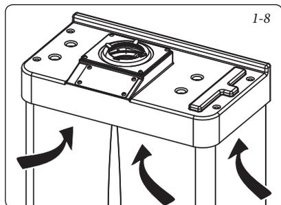
los kit de aspiración / descarga horizontales concéntricos Ø60/100 y Ø80/125 (ver apartado relativo a la instalación en interiores). En esta configuración el Kit de cobertura superior que garantiza una protección adicional a la caldera, es recomendable pero no obligatorio.
