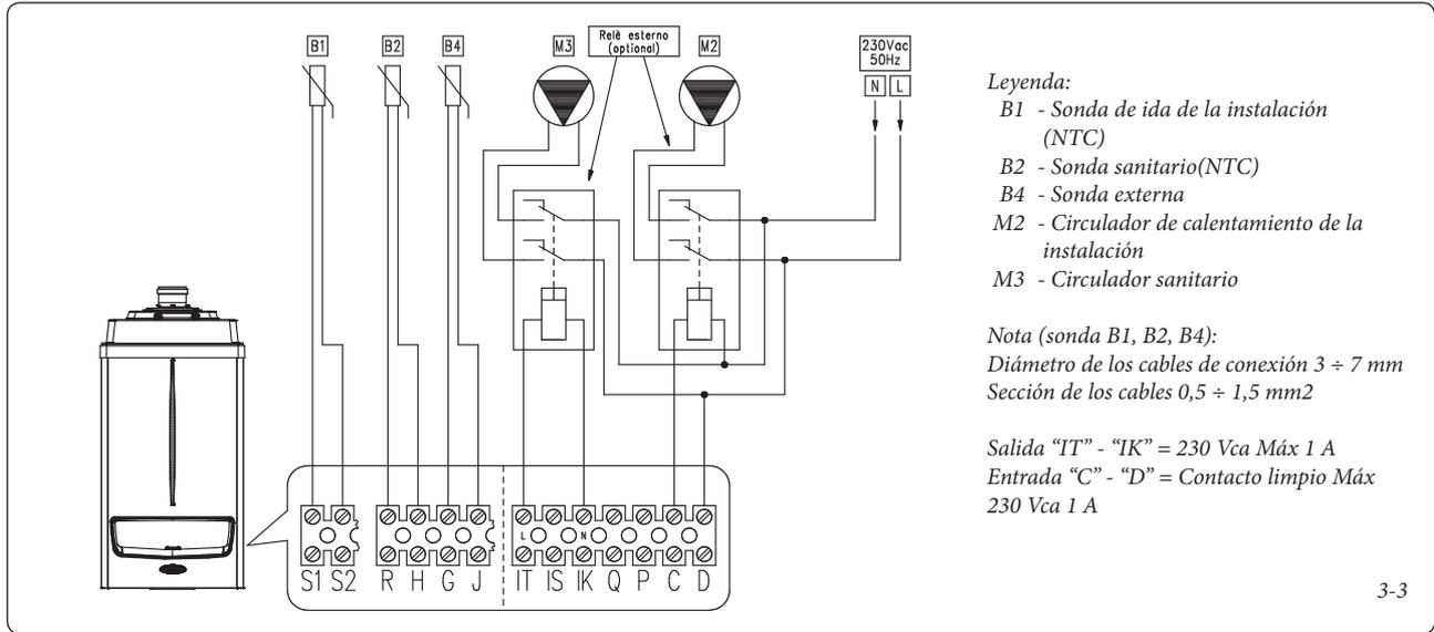
**3.4 ESQUEMA ELÉCTRICO DE LA CALDERA CON SONDA DE IDA DE LA INSTALACIÓN COMÚN DE 3 VÍAS.**
