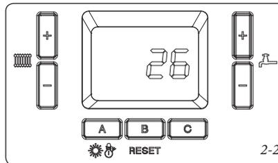
En caso de que se solicite, la caldera se enciende y se visualizan los símbolos correspondientes indicando la temperatura que ha detectado la sonda de impulsión.
