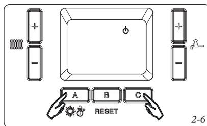
En esta modalidad la caldera se puede considerar alimentada pero no activa, en este caso se garantiza la función antihielo del aparato. Para volver a encender es suficiente presionar el pulsador "B".
