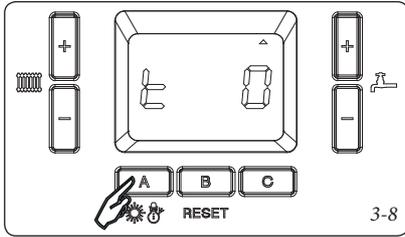
En caso de presencia de la sonda de ida común, se puede activar la función deshollinador pulsando a la vez las teclas "A" y "B", en este caso además de la caldera se activa también el circulador de la instalación (en la "cascada simple" se accionan ambas calderas con la lógica de la cascada).
