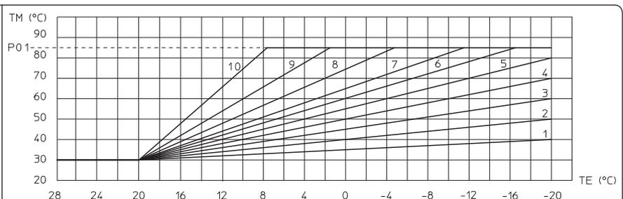
*Nota: el presente gráfico se ha realizado con el valor de offset (P15) a 30 °C (valor por defecto), cambiando el valor de offset se cambia, en consecuencia, el origen de la curva de la temperatura de impulsión y no la inclinación.
