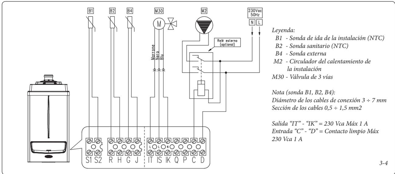
**3.5 ESQUEMA ELÉCTRICO DE CALDERAS EN CASCADA SIMPLE CON CIRCULADOR SANITARIO Y SONDA DE LA UNIDAD ACUMULADOR.**
